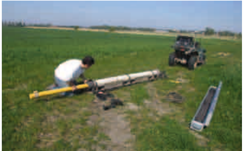
De zeer gevoelige en hoogtechnologische sensor zit in een slede en wordt over het terrein voortgetrokken door een terreinvoertuig met GPS.
